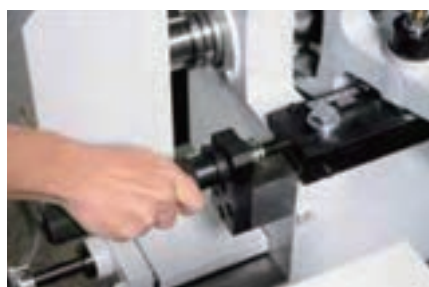
微調整ハンドル Fine adjustment handle 面取り量は、左右のハンドルで微調整できます。 The amount of chamfering can be fine-tuned with the left and right handles.
