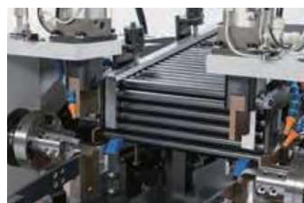
エアシリンダーチャッキング方式 Air cylinder chucking system
