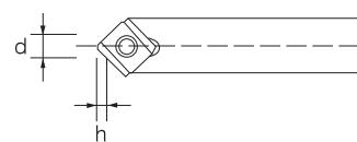
d : 加工径 Cutting diameter
