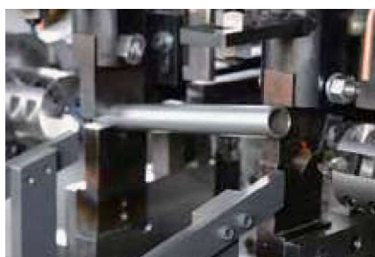
ミスチャックセンサー Chucking error sensor ミスチャックが起きた場合でも、ワークやインサート、バイトの破損を防ぎます。 In the event of chucking errors, damage to workpieces, inserts, and turning tool holders can be prevented.
