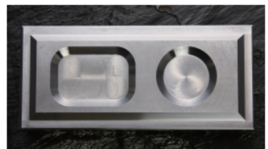
ランピング加工 Ramp cutting
