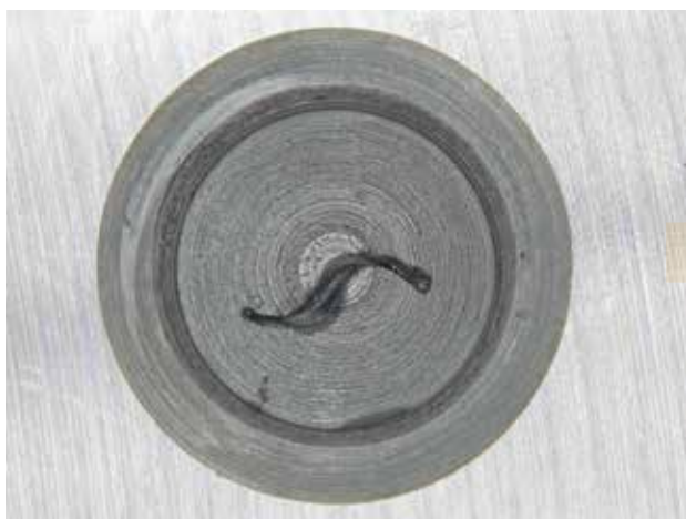
ドリルなどの切りくずが残る
